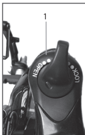
Figuur 4 Instellen van de verende voorvork
