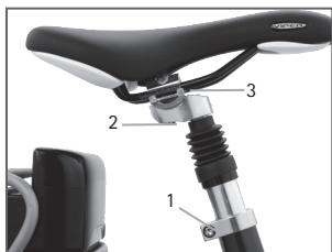
Figuur 2 Instellen zadelhoogte en zadelstand
